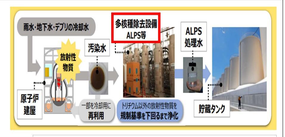
▶ALPS(advanced liquid processing system:多核種除去設備)は、汚染水を浄化処理することによって、トリチウム以外の放射性物質の水中濃度が環境放出の際の「規制基準値」を下回るよう、所定の放射性物質を除去する設備。
